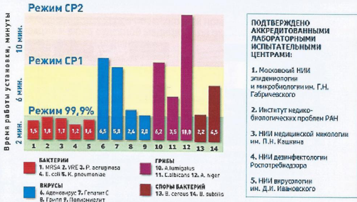
Рис. 3. Время и режимы обеззараживания установкой УИКБ-01-"Альфа" воздуха помещения 100 м 3 от микрофлоры с эффективностью 99,9–99,99%
