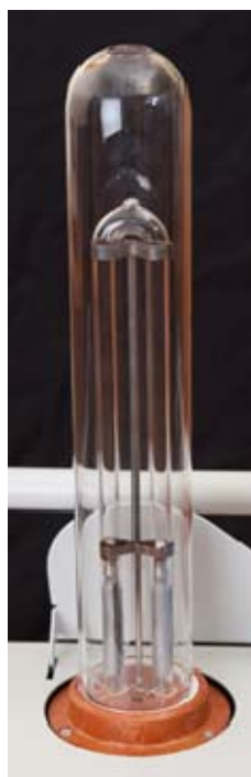
Рис. 2. Импульсная ксеноновая лампа ФК 22/150
