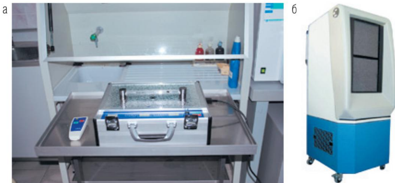
Рис. 12. Примеры устройств обеззараживания воздуха: а – переносной импульсный УФ-облучатель; б – передвижное УОВ
