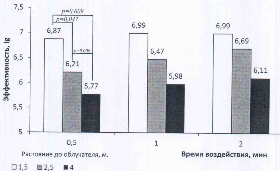
Рис.10. Влияние на эффективность обеззараживания горизонтально расположенных тест-поверхностей, контаминированных MRSA, расстояния от одного облучателя установки «Альфа-02» при разном времени её воздействия (третья серия)
