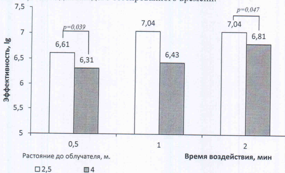
Рис.8. Влияние времени воздействия двумя облучателями установки «Альфа-02» на эффективность обеззараживания тест-поверхностей, загрязненных VRE с белковой нагрузкой (вторая серия)
